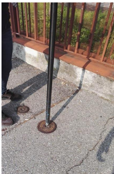
Posizionamento del GPS al centro del chiusino
