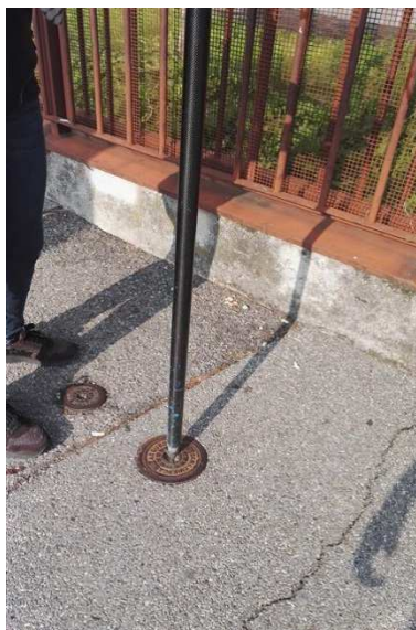
Posizionamento del GPS al centro del chiusino
